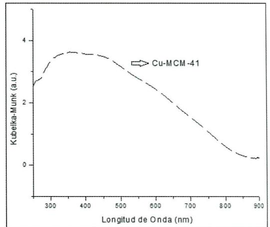
Figura 2. UV-Vis-RD de la muestra Cu-MCM-41.
