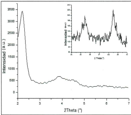
Figura 1. Patrón XRD de la muestra Cu-MCM-41.
