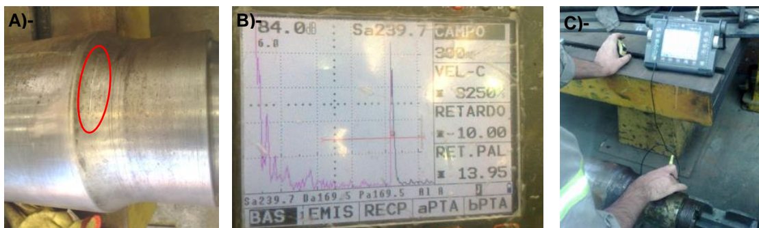
Fig. 1.- Ejemplo de ensayo por UT de un eje, gentileza de Argentren - Línea General Roca. A)- Defecto practicado para la calibración de la técnica UT. B)- Indicación en el equipo del defecto de referencia. Se requiere de personal muy experimentado para interpretar las señales y discriminar los defectos de los ecos geométricos. A pesar de que el equipo es digital, la información no se puede extraer fácilmente para generar un reporte, lo más frecuente es capturar las indicaciones de pantalla mediante fotografías. C)- Exploración manual del eje, aplicando la técnica de UT por contacto.
