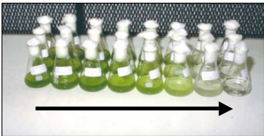
Figura 3. Ensayo de toxicidad con algas. El recipiente de la izquierda en la foto no tiene agregado de la sustancia (control), la concentración de la sustancia aumenta en el sentido de la flecha.
