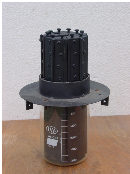
Fig. 3.- Absorbedor del concentrador construido con 10 barras de aluminio pintadas de negro y de sección triangular, dispuestas en forma cilíndrica. No se muestra la cubierta aislante de la parte superior.
