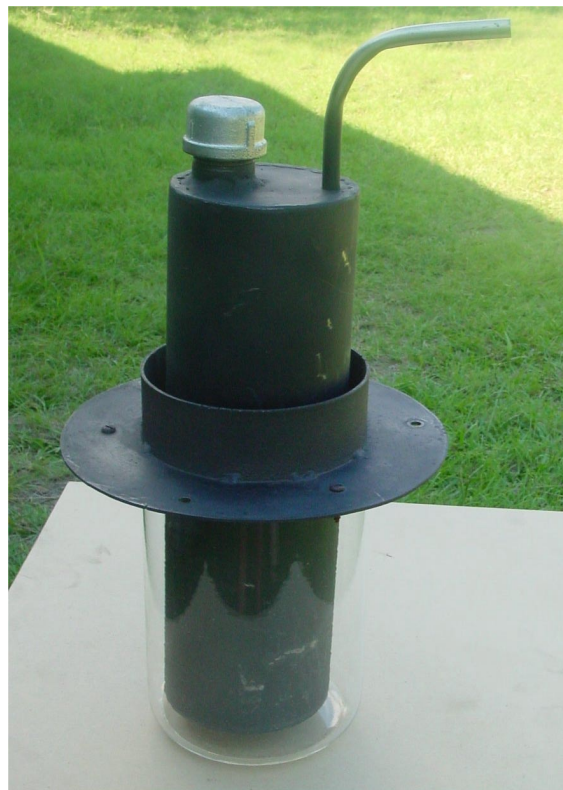
Fig. 2: Muestra el absorbedor tipo caldera donde se cargan 2 litros de agua, la que llega a hervir produciendo vapor que sale por uno de los caños y es transportado con una cañería flexible.
