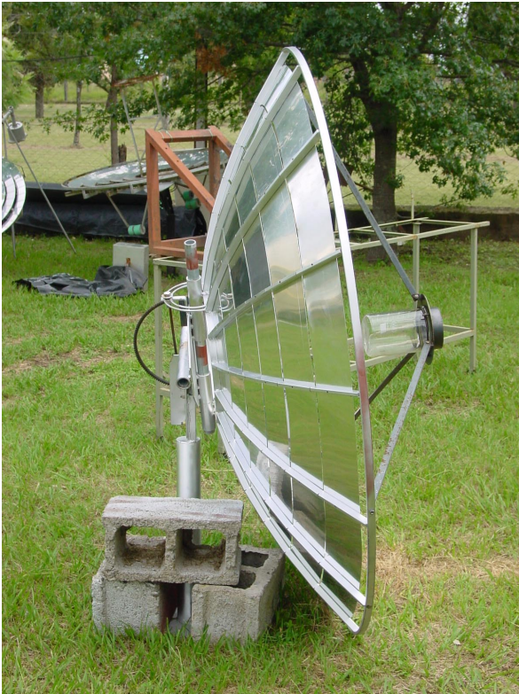
Fig. 1: Muestra una vista lateral del concentrador de perfil curvo donde se aprecia que los aros consecutivos se apoyan directamente en los brazos y no dejan espacio libre entre ellos.
