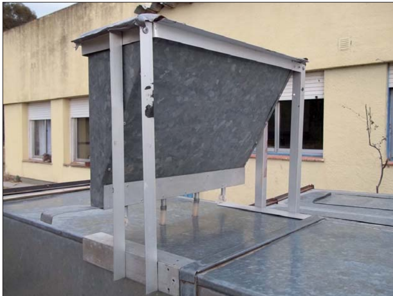
Figura 2. Vista de la tolva para saltación. Figure 2. View of the saltation device.
