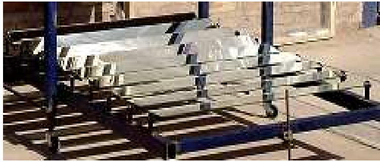
Figura 4: reflectores laminares inferiores en su soporte de caño.
