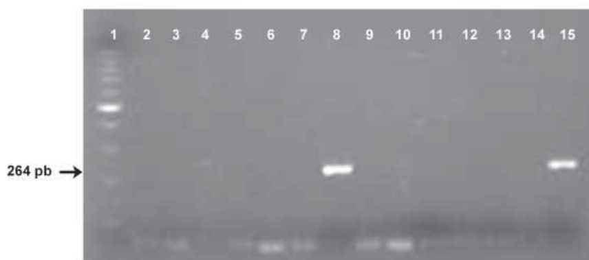
Fig.3. Ensayo de PCR para la detección del gen cfp en plantas de soja sanas. Calle 1: Marcador de PM 100-1000bp DNA Ladder (InbioHighway, Argentina); Calle 2: blanco de reactivos (agua milliq); Calles 2-7 y 9-14: ADN plantas sanas; Calles 8 y 15: ADN de C. kikuchii NBRC 6711 (Control positivo).
