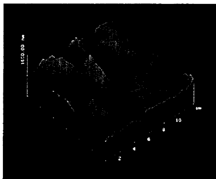
Figura 1.- Micrografía de la cara interna de un catéter de PVC obtenida por AFM. El material ha sufrido un aumento de la rugosidad inicial (nuevo 22 nm - actual 119 nm) luego de ser sometido a sucesivas y numerosas re-esterilizaciones debido a la pérdida de un aditivo incorporado a la formulación.
