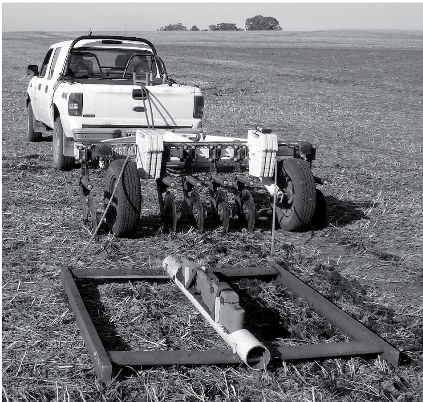
Figura 2. Disposición en tándem de los equipos (Veris 3100 y EM38-mk2).
