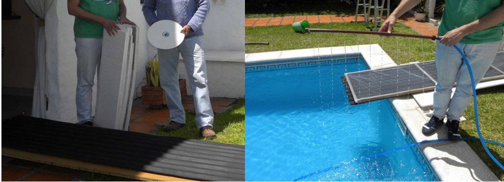
Figura 5: Chapa colectora, placas aislantes y polarímetro y : Sistema de distribución a cada uno de los canales
