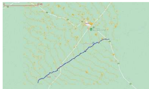
Figura 1.- Área de Interés, con curvas de nivel de elevación cada 2 metros y trazado del arroyo Azul a lo largo de 26 kms, la pendiente promedio es inferior a una milésima.
