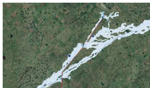
Figura 2.- Máxima extensión de inundación obtenida con el modelo Lisflood-FP SGC sobre el modelo digital de elevaciones FABDEM, en presencia del terraplén de ruta.
