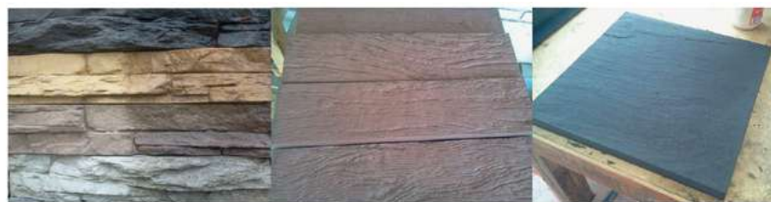
Fig. 4: Diferentes modelos de piezas fabricadas con 50% de AP. Fuente: Elaboración propia
