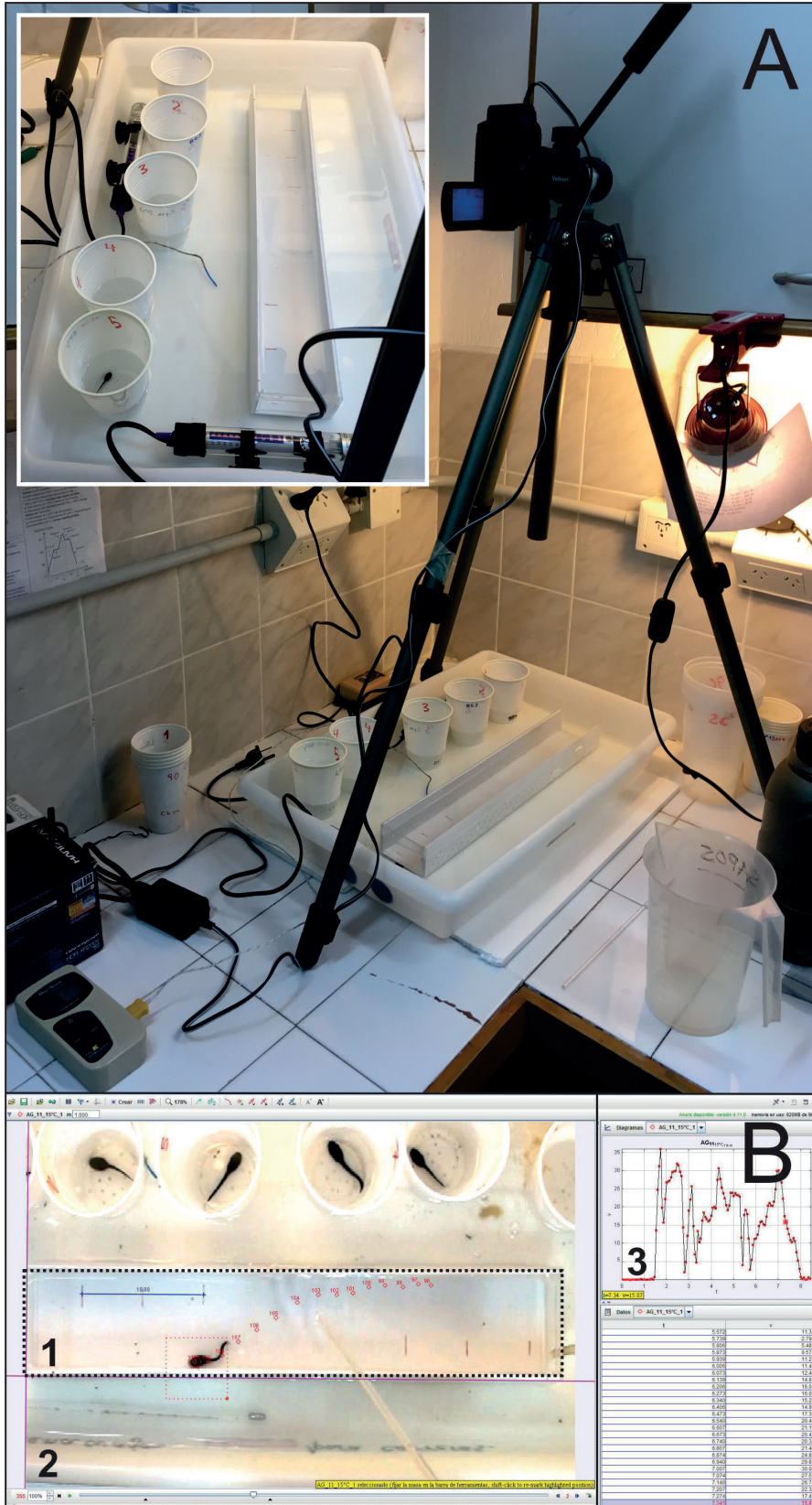
Figura 4.7.16. Arriba (A), set de filmación para evaluar el rendimiento locomotor en renacuajos. Se puede observar una cámara filmadora en posición cenital, el baño térmico constituido por un receptáculo, o “acuario” de mayor tamaño, conteniendo la canaleta de acrílico, que constituye la “pista” (detalle en recuadro superior). Abajo (B), captura de imagen de la interface del software para videoanálisis Tracker©, en el mismo se puede observar (vista cenital) el dispositivo para el ensayo de locomoción de renacuajos, compuesto por: 1) la pista donde se estimula la natación de los ejemplares (marcada en línea punteada), la misma se encuentra inmersa en 2), el acuario que funciona como baño térmico en el que se controla la temperatura del ensayo, y 3) paneles del software que muestran una curva del seguimiento de la velocidad en tiempo real y los valores tabulados de tiempo y velocidad (37,40) . Fotos: M. Bonino.
