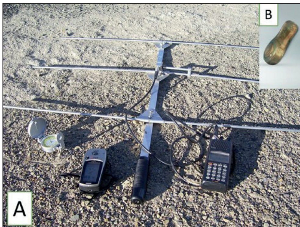
Figura 4.7.5. A) Equipo de radio telemetría estándar con el que se puede estimar la locación de los individuos y la temperatura corporal de los mismos. B) Unidad emisora con la cual se puede obtener, además, la temperatura corporal de los animales. Foto: E. Sanabria.
