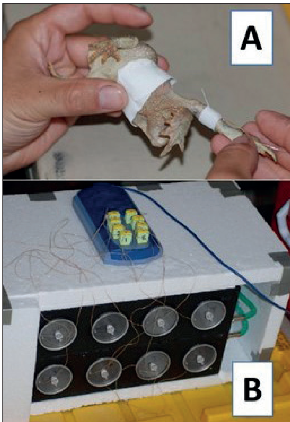
Figura 4.7.10. Equipamiento utilizado para determinar las temperaturas críticas mínimas y punto de cristalización. A) Forma de anclar la termocupla para evitar gérmenes de cristalización. B) Cámaras para la disminución de la temperaturas. Las mismas permiten ver los ejemplares a medida que la temperatura disminuye y evaluar su condición (39) . Foto: E. Sanabria.
