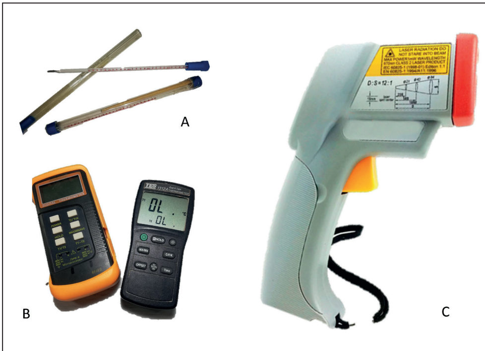
Figura 4.7.1. Termómetros comúnmente usados para registrar la temperatura corporal. A) Termómetro clásico de mercurio o alcohol. B) termómetro electrónico con termocupla, y C) termómetro infrarrojo el cual no necesita hacer contacto directo con el individuo para registrar la temperatura. Foto: E. Sanabria.
