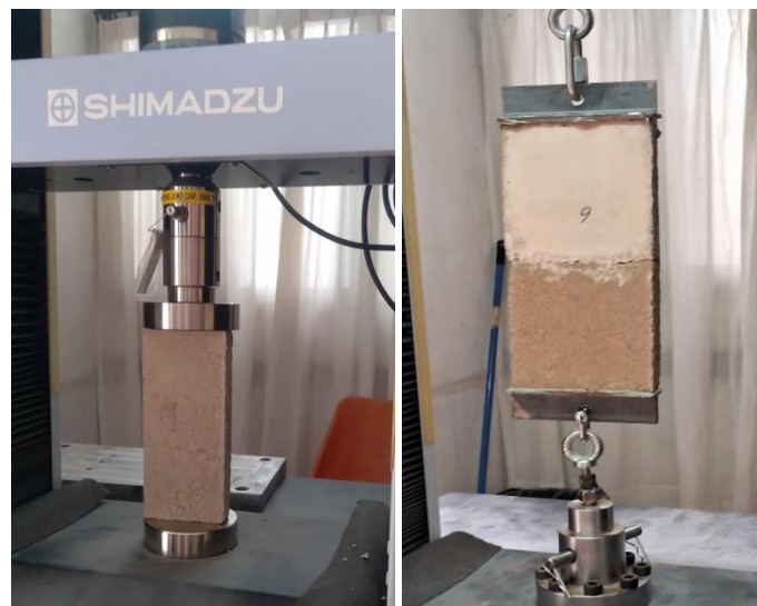
Figura 5. a) ensayo de resistencia a la compresión de la bovedilla-BTC. b) ensayo de tensión de adherencia de la bovedilla-BTC
