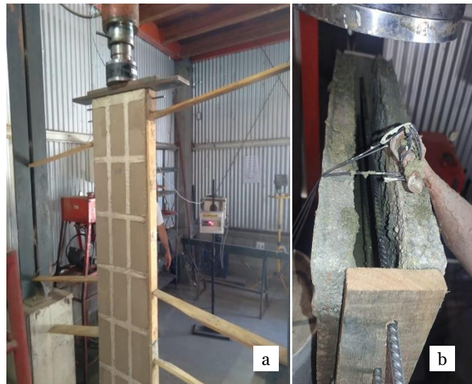
Figura 4. a) armado del muro BENO con bovedilla-BTC en la zona de prensado. b) armado de la viga de encadenado
