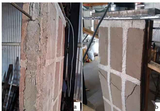
Figura 8. Ensayos de resistencia a la compresión de los muros BENO. a) Muro BENO, se observa la rotura en el encadenado superior. b) Muro BENO-BTC, se observa la rotura en las bovedillas-BTC. Fuente: elaboración propia.
