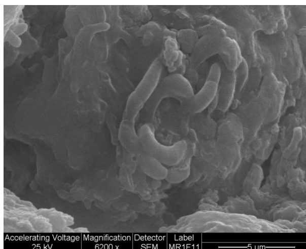
Figura 2. Comunidad microbiana compleja biodeteriorante de mármol (6200X). Cementerio de La Recoleta.
