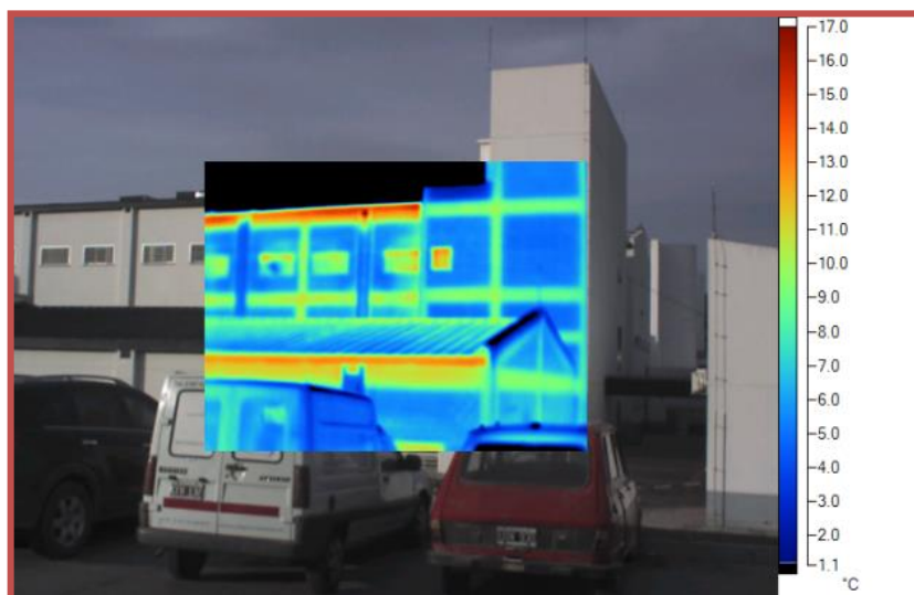
Fig. 7. Imagen termográfica del Nuevo Hospital de Niños, Salta. Se observan las pérdidas de calor a través de la estructura de hormigón.
