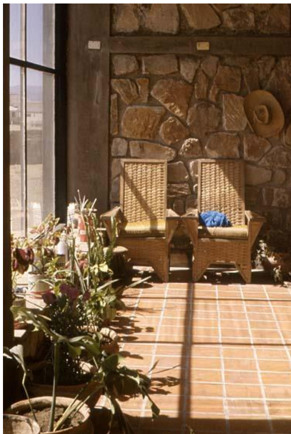
Fig. 1. Ganancia solar directa. Sub Estación experimental del INTA en Abra Pampa, a 3500 m snm. Puna Jujeña, Argentina.
