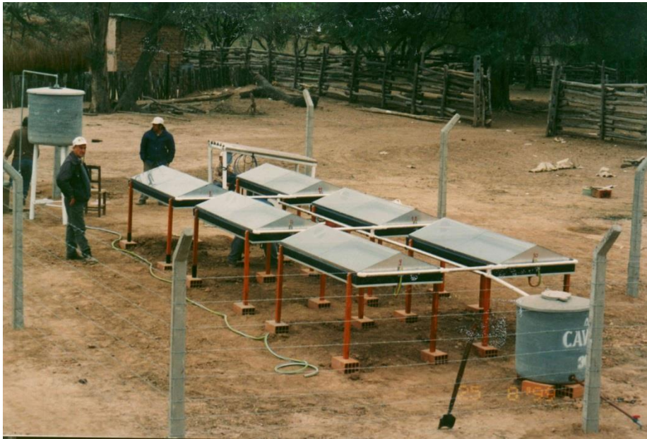
Figura 3. Destiladores solares en la localidad "El Quemado". Abastece de agua a dos familias
