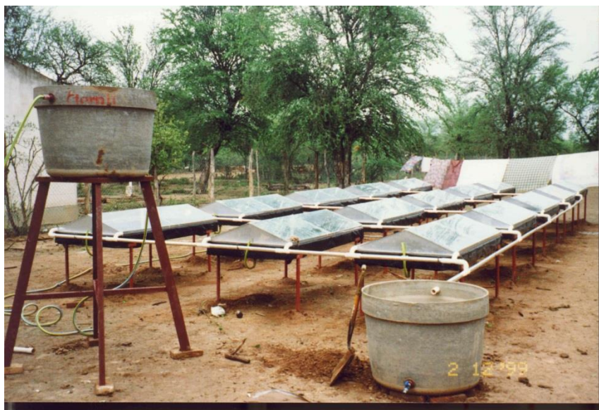
Figura 2. Destiladores solares en la localidad "Pozo la China". Abastecen de agua a una escuela de 40 alumnos
