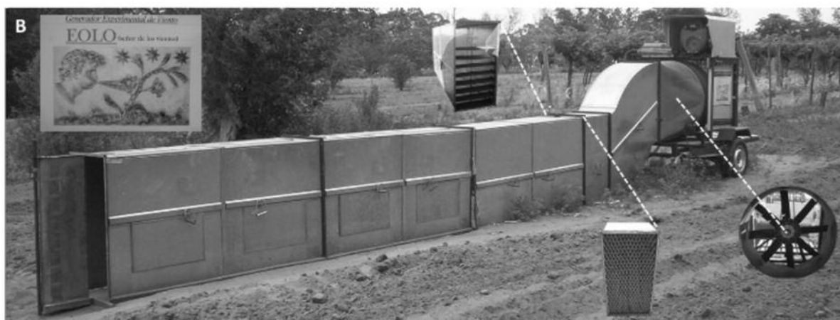
Figura 4. A) Diagrama de los componentes del túnel de viento portátil. B) Vista del túnel de viento portátil y detalles de 1) Placas deflectoras, 2) Placa criba y 3) Hélice. Tomado de Colazo et al. (2016).
