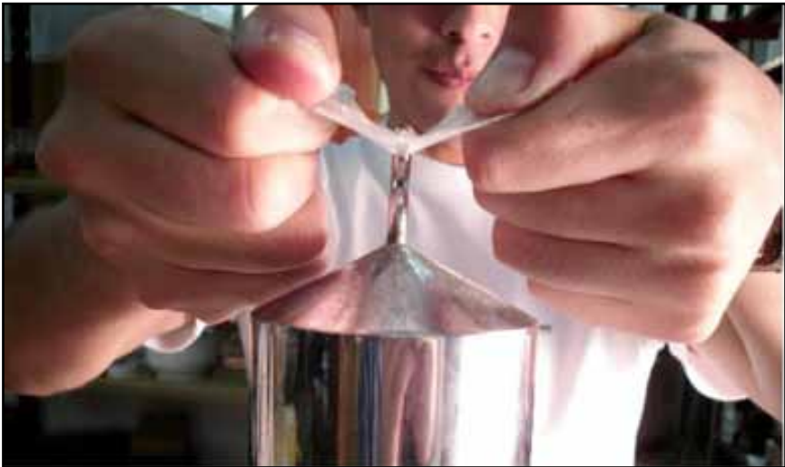
Figura 22: . Ensayo de resistencia a la carga en films de almidón.
