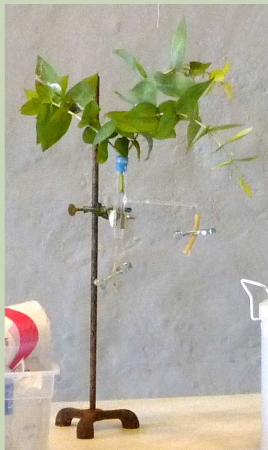
Figura 2: Potómetro utilizado por los estudiantes para estimar la velocidad de pérdida de agua en las plantas causada por la transpiración en el desarrollo de las actividades de la Estación N° 2 durante el taller.
