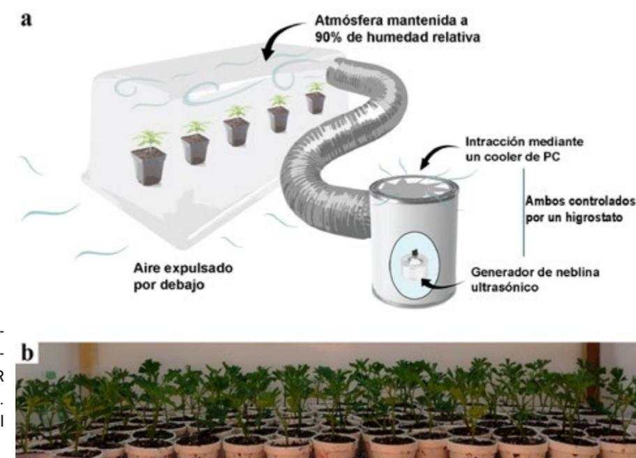
**Figura 1. a.** Esquema de humidificador automático empleado para mantener la HR en el domo de enraizamiento. **b.** Esquejes ubicados en el domo de enraizamiento.
