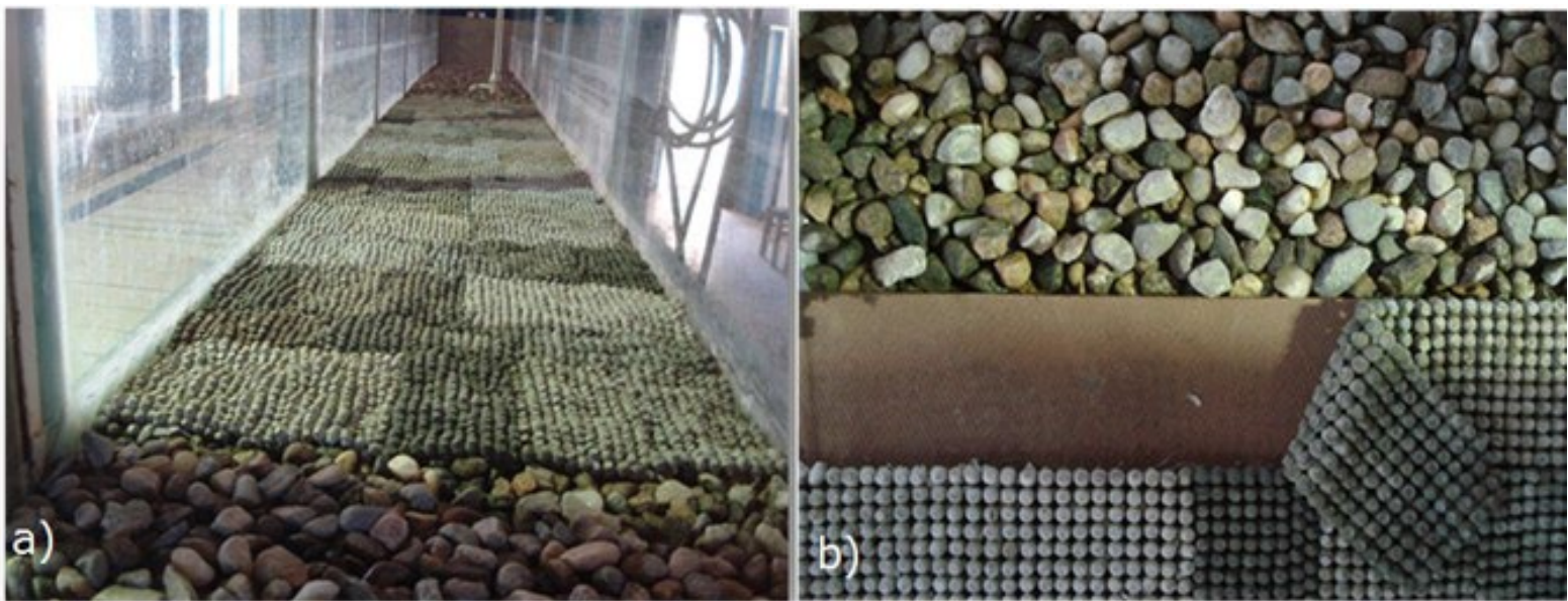
Figura 9. a) Sistema de protección colocado sobre fondo rugoso de gravas, visto desde agua abajo, ( foto del caso de fondo levemente ondulado naturalmente ), b) los experimentos fueron con mantas apoyadas en un fondo plano de madera.
