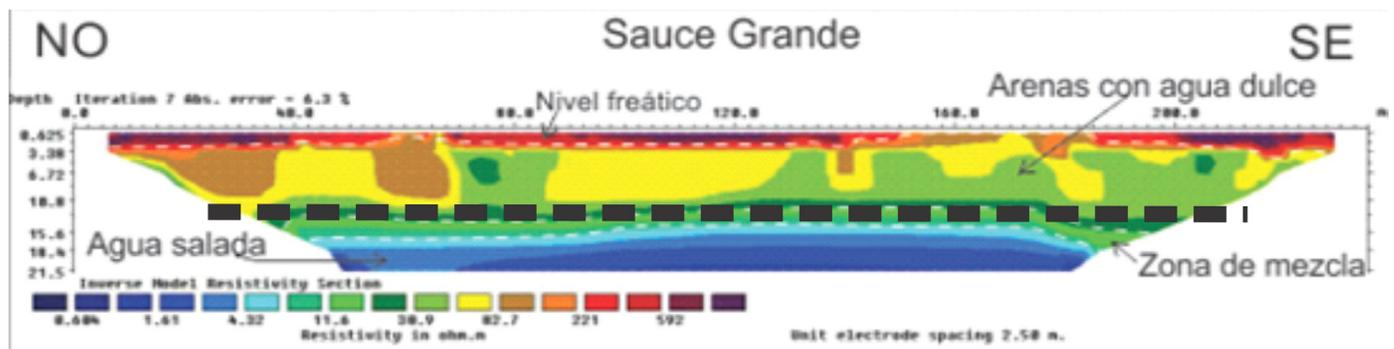
**Figura 10:** Perfiles de resistividad de la Barrera Austral en Sauce Grande (modificado de Albouy et al. 2020). Los colores rojos y amarillos indican agua dulce mientras los azulados son salinos. La línea cortada indica la interfase agua dulce-salada horizontal.
