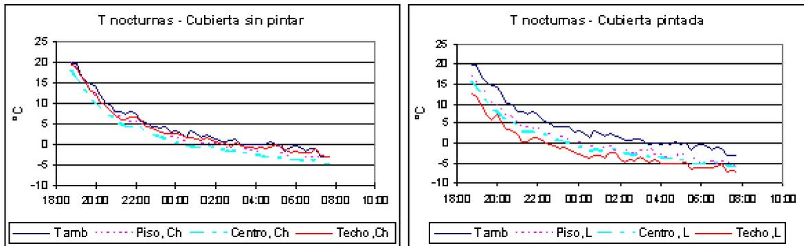
Figura 10. Evolución nocturna de las temperaturas en el modelo a) con cubierta sin pintar y b) con cubierta pintada.
