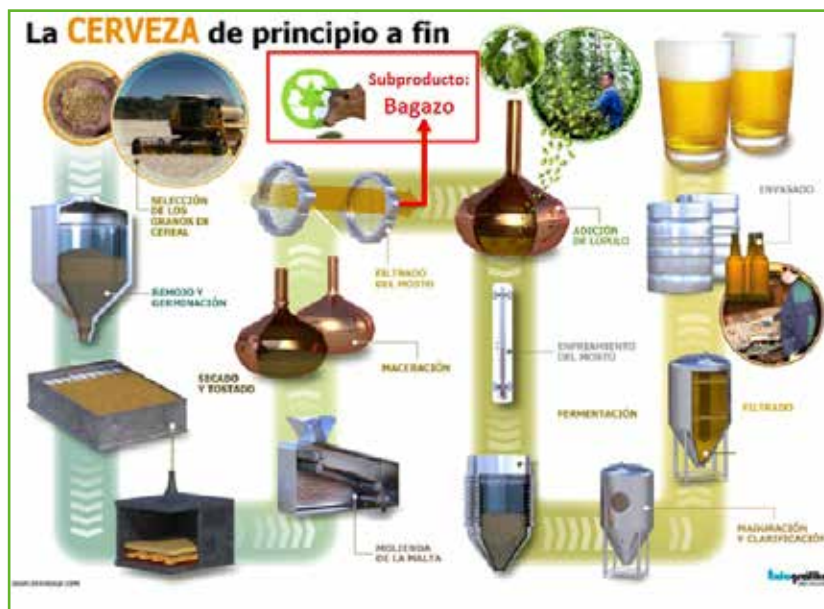
Figura 1: Proceso de elaboración de cerveza y generación del bagazo como residuo (Adaptado de: página oficial de www.cervecear.com ).
