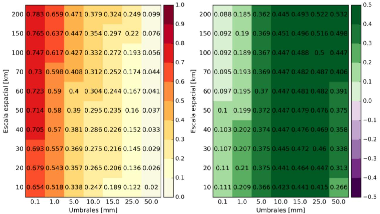
Figura 12: Fractional Skill Score del GEFS (izq.), y diferencia del GEFS respecto del **ens.ctrl** (der.) computados con los pronósticos probabilísticos de precipitación acumulada a 6 h sobre las 42 h del periodo de verificación.
