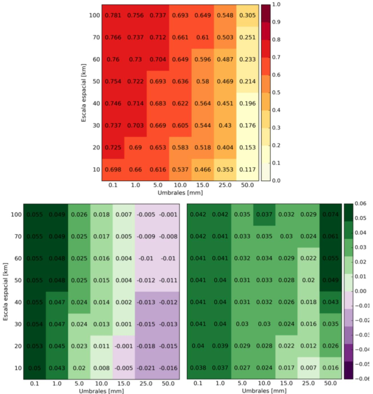
Figura 8: Fractional Skill Score del **ens.cntl** (arriba), y diferencia del **ens.multi** respecto del **ens.cntl** (abajo izq.) y del **ens.pert** respecto del **ens.cntl** (abajo der.) computados con los pronósticos probabilísticos de precipitación acumulada a 3 h sobre las 42 h del periodo de verificación.
