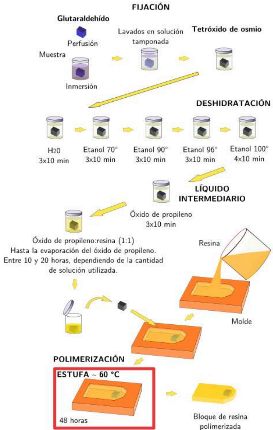
Proceso de inclusión en resinas de tipo epoxy.
