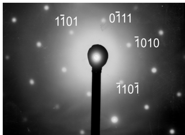
Fig. 8. Patrón de difracción de electrones de la muestra obtenida por el método cinético con 0,5 h de crecimiento, según plano [0001].
