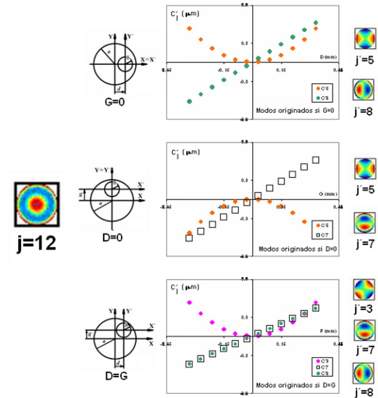
Figura 6. Variación de coeficientes Zernike correspondientes a astigmatismo ( $C_3'$  y  $C_5'$ ) y coma ( $C_7'$  y  $C_9'$ ) al descentrar la pupila en los casos  $G=0$  (arriba),  $D=0$  (centro) y  $D=G$  (debajo) si  $B=2/3$ ;  $C_{12}=1\mu\text{m}$  y los otros coeficientes  $C_j$  son nulos
