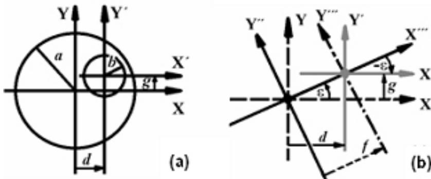
Figura 2. Coordenadas originales  $((X, Y))$  y nuevas  $((X', Y'))$  para escaleo y traslación arbitraria de la pupila. (a): pupilas original y nueva. (b): Transformación de coordenadas obtenida mediante una rotación en un ángulo  $\epsilon$  (siendo  $(X'', Y'')$  coordenadas rotadas), luego un escaleo y traslación a lo largo del eje  $X''$  (siendo  $(X''', Y''')$  coordenadas rotadas y trasladadas) y finalmente una rotación en un ángulo  $-\epsilon$ .
