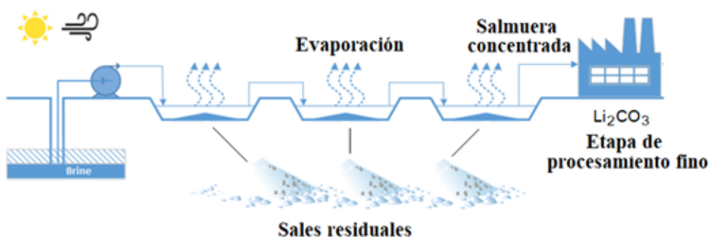
Fig. 1: Esquema de las etapas de evaporación previas al procesamiento fino del carbonato de litio. Las sales residuales se acumulan junto a los estanques de evaporación.
