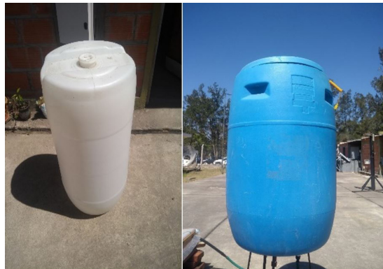
Figura 6. Fotos de los tanques reciclados utilizados para hacer el tanque de acumulación y esquema de la disposición de la aislación.
