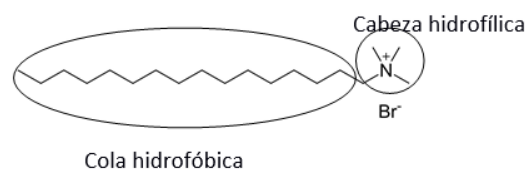
Figura 4-7. Estructura molecular de un surfactante catiónico típico (bromuro de cetiltrimetilamonio).
