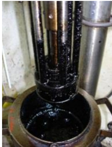
Figura 4-2. Dispersor de asfalto tipo rotor-estator Fuente: elaboración propia
