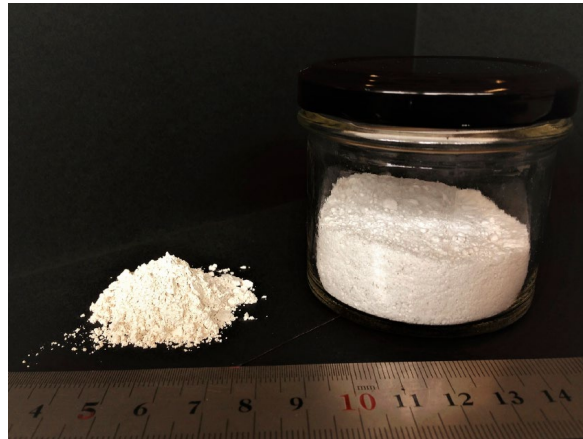
Figura 4-2. Izq: CaCO 3 (filler), fracción menor a 63 \mu\text{m} . Der: nanosilica. Dispensor de asfalto tipo rotor-estator
