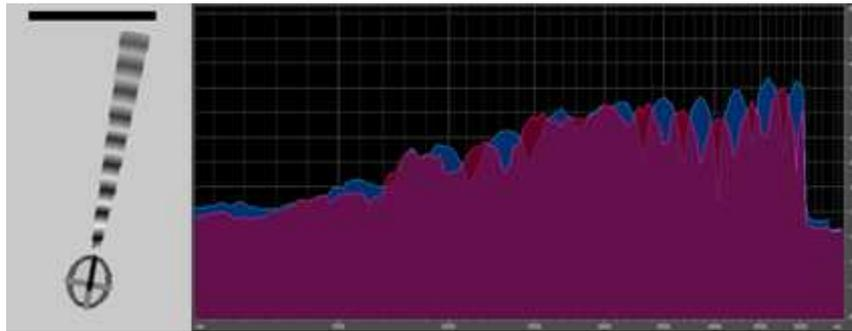
Figura 7: Espectro de frecuencias con el blanco reflectante enfrentado a 15° (abajo). A la izquierda se observa un diagrama de la emisión de la señal a 15 ° del centro del blanco reflectante y a la derecha la gráfica espectral de esta situación.
