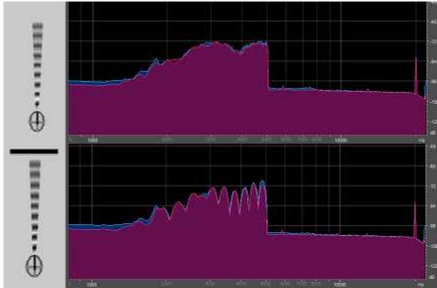
Figura 6: Espectros de frecuencias de la grabación binaural. A la izquierda se observa un diagrama de la emisión de la señal sin y con blanco reflectante al frente (en la parte superior e inferior respectivamente). A la derecha están las gráficas espectrales correspondientes a estas situaciones.
