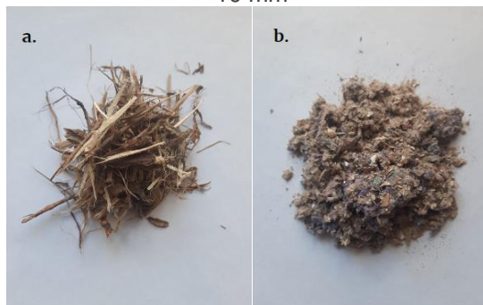
Figura 2. a. Poda urbana: mulch triturado en chipeadora en forma de fibras de un tamaño entre 10-30 mm de longitud / b. Cartón: Se tritura en molino de 4,5 hp hasta lograr partículas de tamaño entre 0-10 mm
