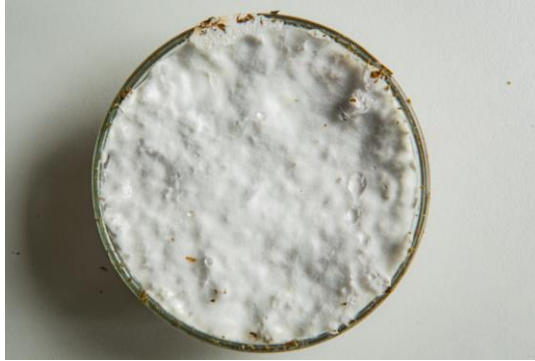
Figura 4. Prototipo de panel de micelio deshidratado
