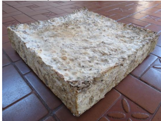
Figura 5. Comparación del biopolímero fúngico con densidad de productos aislantes comerciales
