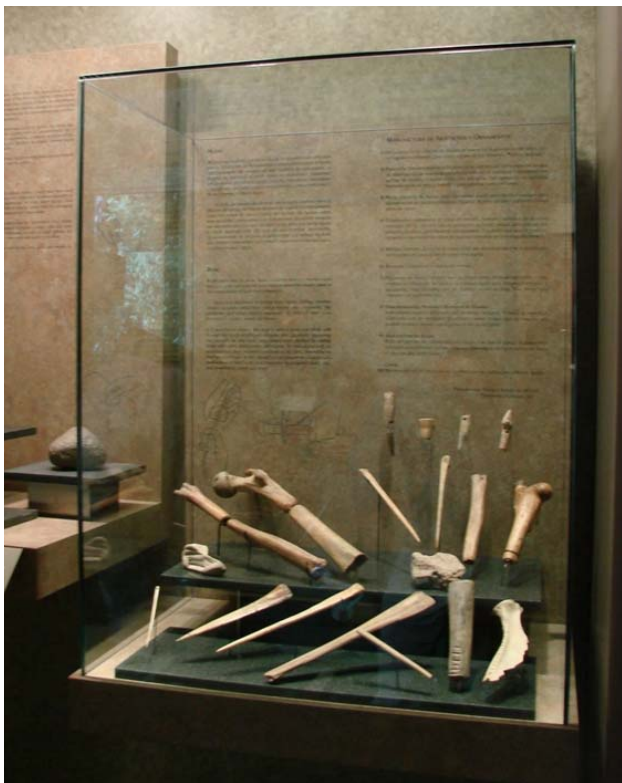
Figura 2. Reestructuración de una de las grandes vitrinas de la Sala Preclásico donde se incorporó un capelo de vidrio sellado para resguardo de material óseo. Además incluye gel de sílice para control de la humedad y un dispositivo de monitoreo de la misma.
