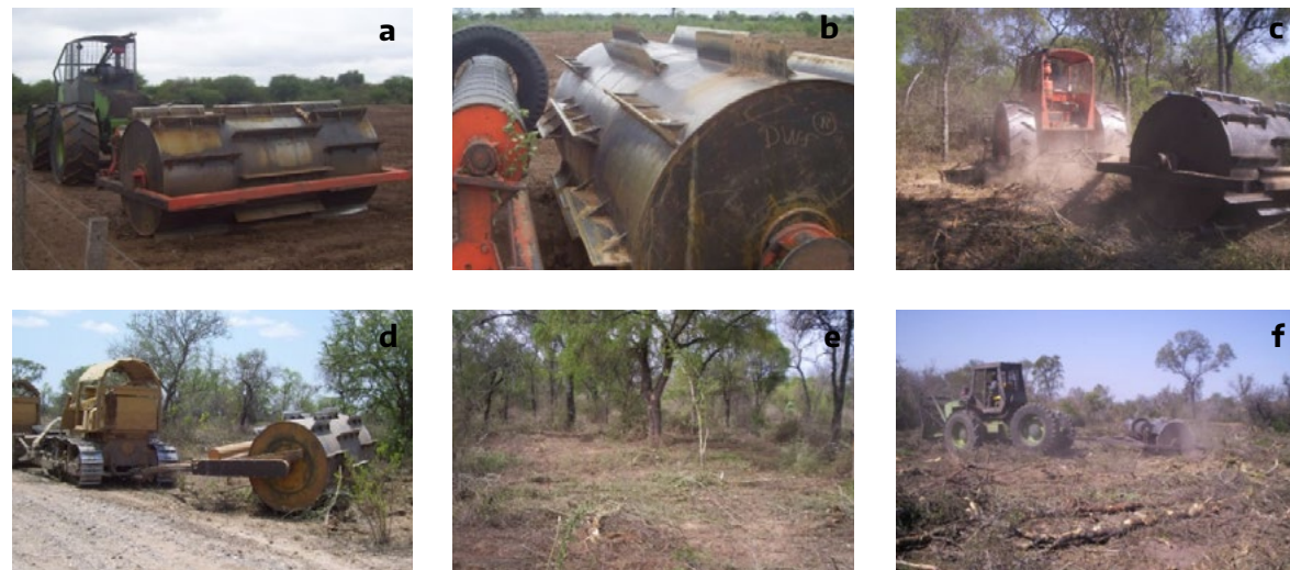
Figura 10.5. Herramientas mecánicas disponibles para implementación de un planteo silvopastoril: detalles de rolos con sembradora y distintas formas de tracción (A, B, C y D). Dos intensidades de rolado: alta (E) y baja (F) (Fotos gentileza Carlos Kunst)
