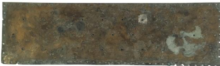
Fig. SEQ Fig. \* ARABIC 15 Lámina de Muntz asociada al forro externo del pecio, archivo INAH/SAS.
