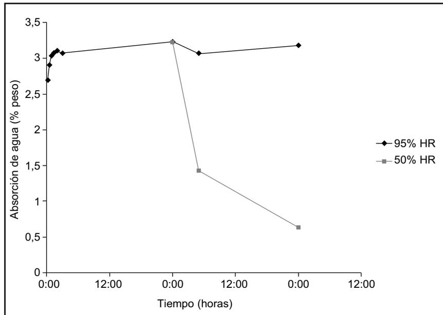
Figura 4. Curva de absorción y retención de agua a 24 horas.
