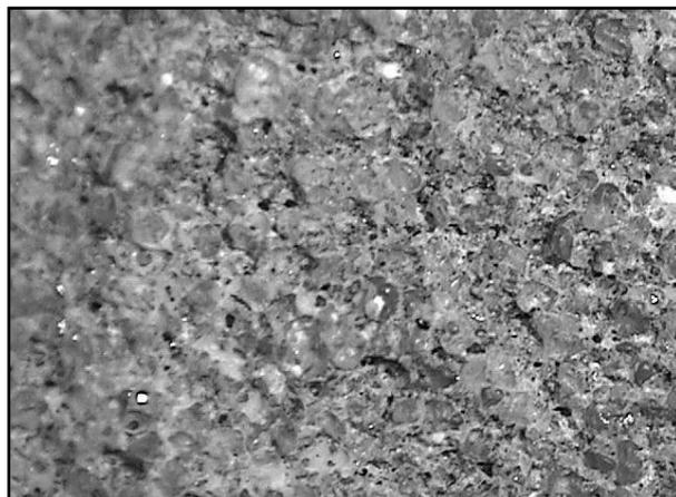
Figura 3. Corte delgado de arenisca de las misiones visto en microscopio con luz normal.
