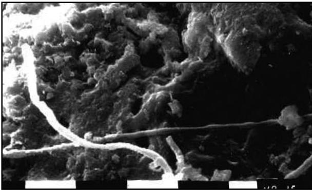
Figura 8. Fotomicrografía MEB de *Caloplaca sp.*: nótese el líquen creciendo alrededor de un clasto de la roca.
