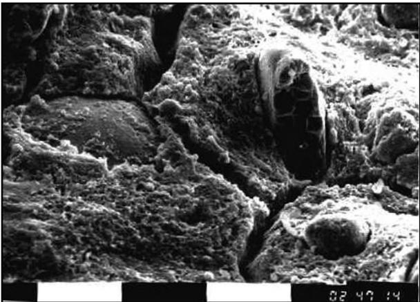
Figura 10. Fotomicrografía MEB de *Buellia sp.* Nótese el líquen penetrando la roca.
