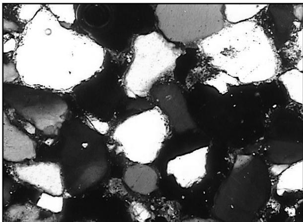
Figura 2. Corte delgado de arenisca de las misiones visto en microscopio con contraste de fases.
