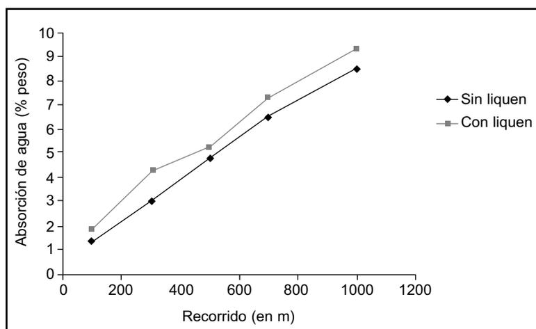
Figura 5. Datos del ensayo de abrasión de las caras no colonizadas y colonizada de una laja de arenisca del piso de las misiones.
