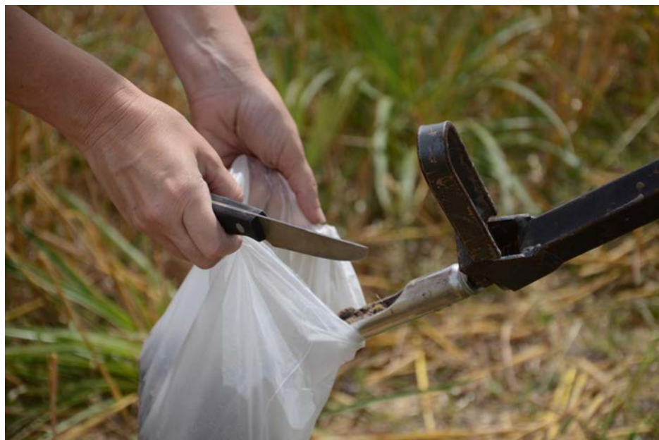
Figura 2. Toma de muestra de suelo con barreno
