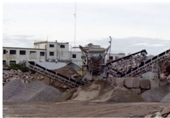
Figura 4. Generación de AR procedente de la demolición de pista de aterrizaje en Aeroparque Jorge Newbery. (Adaptado de [36]).
