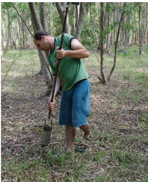
Muestreo de suelo en una plantación de eucaliptus en la pampa deprimida.
