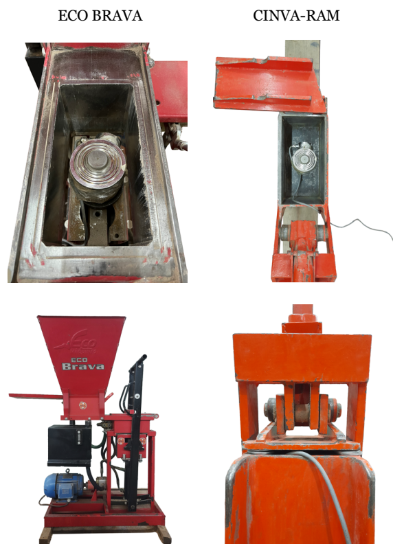
Figura 3. Determinación de la fuerza de compresión efectiva ejercida por las prensas Eco Brava (izquierda) y CINVA-RAM (derecha)
