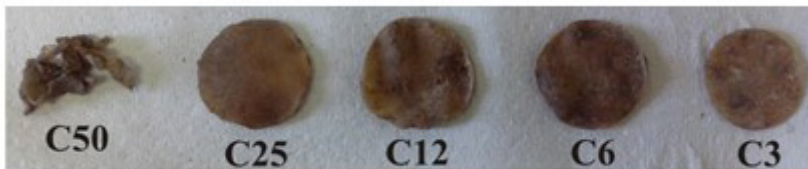
Figura 2.1.2. Imagen de películas degradadas luego de 14 días de enterramiento en suelo (los números contiguos a la letra C indican el contenido de caseína de cada uno de los films analizados)
