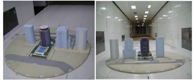
Figura 13: Ensayo del edificio Trump Tower
