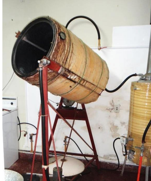
B. Tambor rotatorio con eje excéntrico
