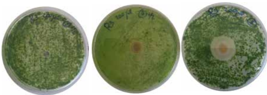
Figura 4. Resultados de ensayos de difusión en placa: a) actividad biocida nula, b) actividad biocida baja, c) actividad biocida alta.
