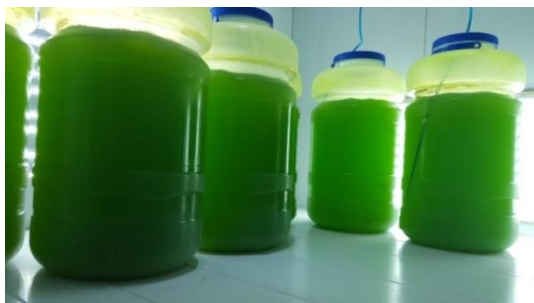
Figura 1. Cultivo de microalga Scenedesmus obliquus en fotobiorreactores de 25 L.
