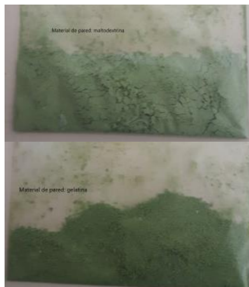
Figura 4. Microalga Scenedesmus obliquus microencapsulada con maltodextrina (izquierda) y gelatina (derecha) como materiales de pared.
