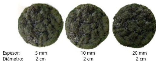
Figura 3. Microalga Scenedesmus obliquus deshidratada por liofilización.
