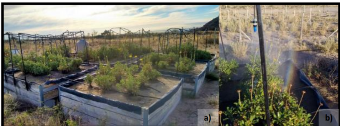
Figura 2 Simulador de lluvias (a) en funcionamiento (b).
