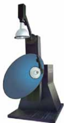
Figura 5. Fotogoniómetro tipo C a espejo.
