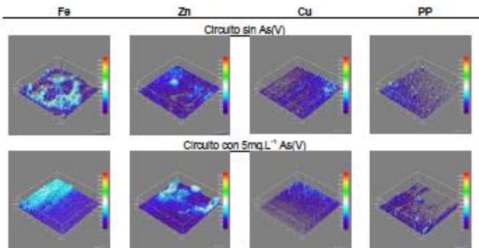
**Figura 8.** Estructuras 3D reconstruidas mediante software a partir de las imágenes tomadas con el MLC, de los cuatro sustratos testeados en presencia y ausencia de As(V).
