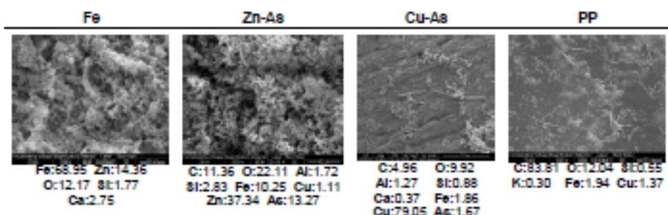
Figura 7. MEB-EDS de las biopelículas desarrolladas sobre los cuatro sustratos ensayados. En la primera fila se indica el sustrato, "-As" indica la exposición al circuito con  $5 \text{ mg.L}^{-1}$  As(V).
