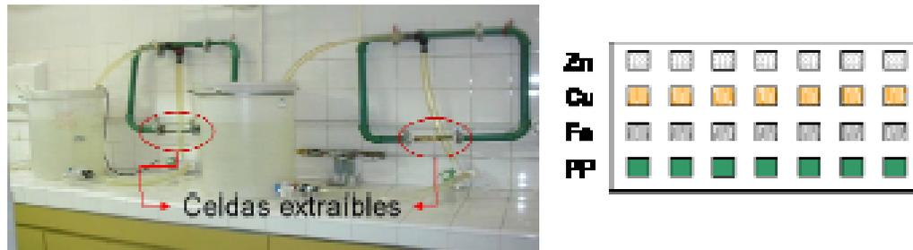
Figura 1. Circuitos de circulación de agua. A la derecha se muestra un esquema de la disposición de los cupones colocados en las celdas extraíbles expuestos en ambos circuitos.
